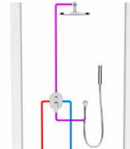
Использование в душевом уголке - вывод воды на ручной и верхний душ
