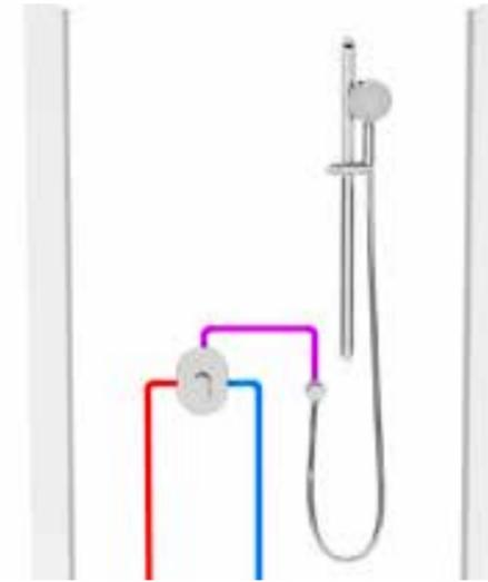
Использование в душевом уголке - вывод воды только на ручной душ
