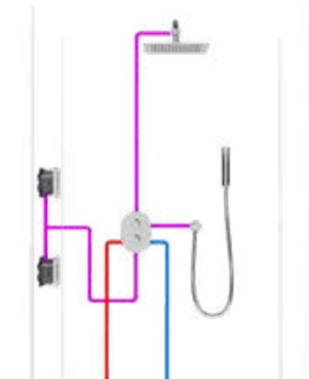
Использование в душевом уголке - вывод воды на ручной душ, верхний душ, в сочетании с гидромассажной панелью.
